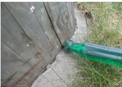
Abb. 1: Mast scheint vom äußeren Erscheinungsbild her funktionstüchtig zu sein, aber das Durchschlag-Werkzeug weist eine enorme Eindringtiefe auf, nachdem die härtere Außenhülle durchstoßen wurde.
