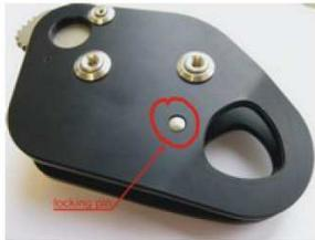
Fehler: Die Niete die das Durchdrehen der Klemmbacke verhindern soll kann falsch eingearbeitet sein und kann sich dadurch lösen. Bis zu diesem Zeitpunkt (08.03.2010) gibt es weltweit keinen einzigen angezeigten Fall eines Unfalles oder Versagens des Gerätes. Es sind keinerlei Verletzungen oder Personenschäden bekannt. Unabhängig davon agiert SINGING ROCK in seiner Verantwortung als Partner und informiert die Kunden / Benutzer über den möglichen Fehler.
